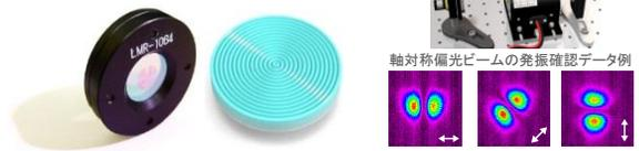
同じ同心円パターン基板でも、膜厚次第で、偏光子の透過軸は同心円状にも放射状にも選択可能。透過率を80~95%程度に調整して、レーザー光の発振ミラーに用いると、軸対称レーザー発振します。
