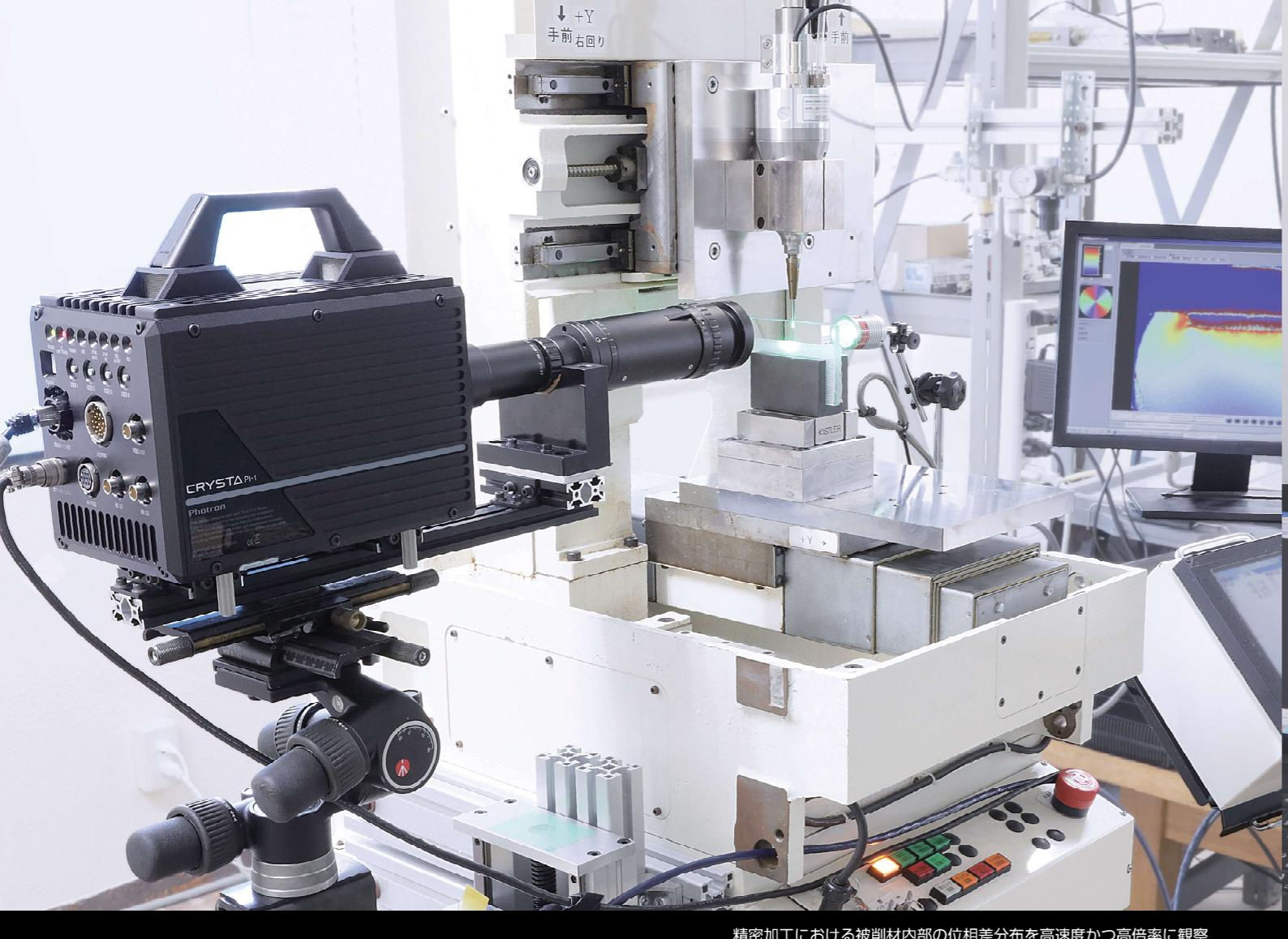
精密加工における被削材内部の位相差分布を高速度かつ高倍率に観察
