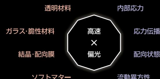
偏光は「振動方向が規則的な光」であり、目視では認識できない光の状態です。光の偏光状態は透過した物体の内部構造や反射した物体の表面形状などによって変わるため、対象物への入射・出射前後の偏光状態を求ることで、様々な物理量の測定や現象の可視化へ応用できることが知られています。さらに、この「偏光」に「高速度イメージング」の技術が合わさることで、例えば、透明材料の加工時に工具へ加わる負荷を画像から検討したり、衝撃試験や流動現象における応力の伝播・緩和過程を可視化する、配向膜の空間的な性能の均一性を非接触で定量的に計測する、など従来では想像もできなかつたような新しい画像計測が可能となります。
