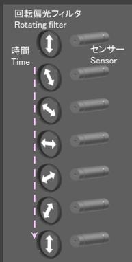
従来のエリプソメータでは、偏光フィルターを回転させる時間が瞬時測定への障害でした。
