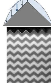
自己クロージングプロセスで成膜した場合の断面SEM(電子顕微鏡)画像
