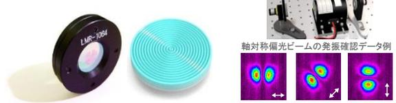
同じ同心円パターン基板でも、膜厚次第で、偏光子の透過軸は同心円状にも放射状にも選択可能。透過率を80~95%程度に調整して、レーザー光の発振ミラーに用いると、軸対称レーザー発振します。
