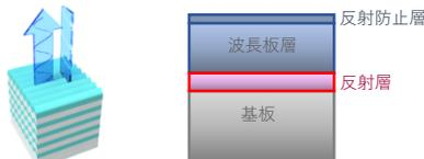
反射光の偏光状態を変化させる、反射型の波長板が実現します。更に、⑦と組み合わせて、反射面の一部に偏光変換作用を持たせることも可能です。
