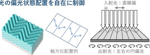
隣接するレーザー光の干渉抑制や、立体映像用フィルター用に。例えば複数個のレーザー発光面に集積波長板を配置すると、隣接ビーム間の干渉を抑えたレーザー照明が実現可能です。
