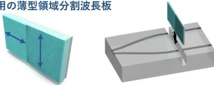
厚さ20μm程度の超薄型の複合波長板も実現可能で、PLC (Planar Lightwave Circuit) の溝に挿入して使うことができます。
