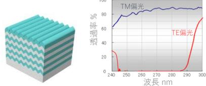
膜厚と凹凸周期を小さくすると、動作波長を250nm程度までの紫外線用偏光子や波長板が実現します。波長266nm用の0次オ
